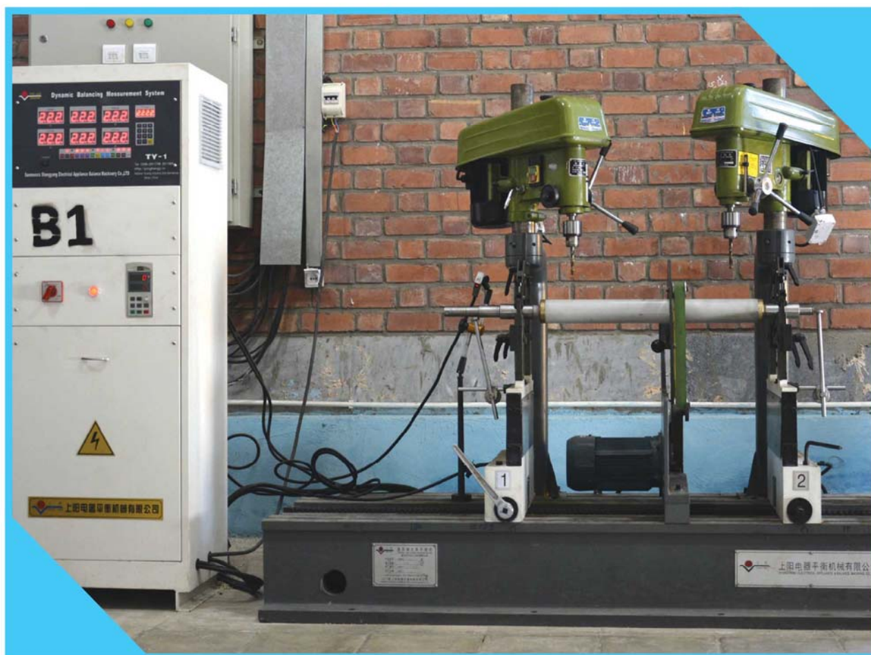
دستگاه تشخیص نابالانسی روتور به روش بالانس دینامیکی
